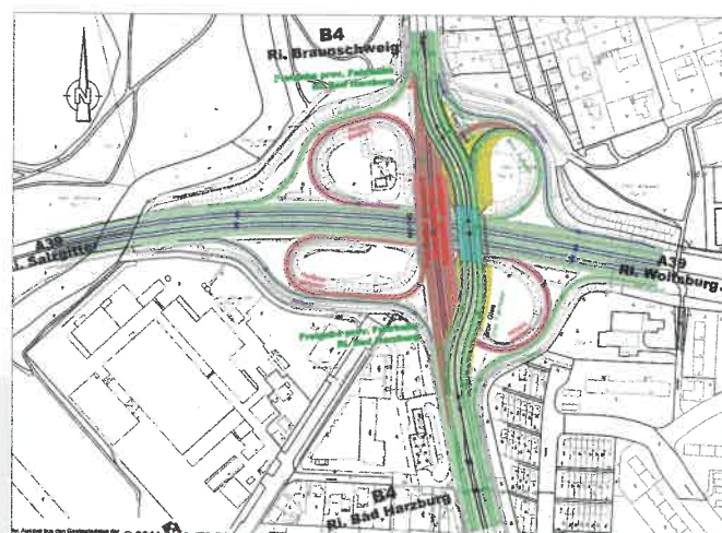
Prinzipmodell der drei Behelfsbrücken, in der Mitte die Stadtbahnbrücke Umleitungsplan für die Verkehrsführung während der Bauzeit
